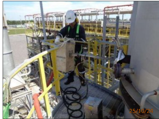
รูปที่ 2-6 เครื่องกังหันก๊าซที่ใช้ขับเคลื่อนเครื่องเพิ่มความดันก๊าซ (Gas Turbine Compressor) และการติดตามตรวจสอบคุณภาพอากาศจากปล่องระบาย
